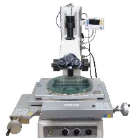
画像処理装置を搭載し、寸法はもちろん二点間距離や円、ピッチ、角度などの計測が可能です。
